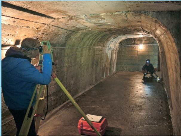
Neuvermessung mit Infrarot-Laser-Totalstation
